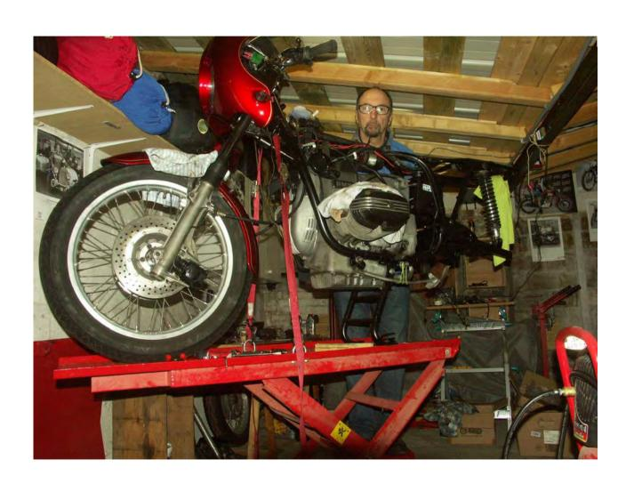
Montage des carburateurs, du couple conique et du deuxième amortisseur arrière.
