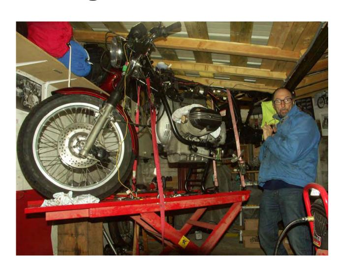
Montage d'un amortisseur arrière et de la batterie. Pour la batterie, il a fallut redémonter tout le filtre à air. Ce n'est pas une sinécure...
